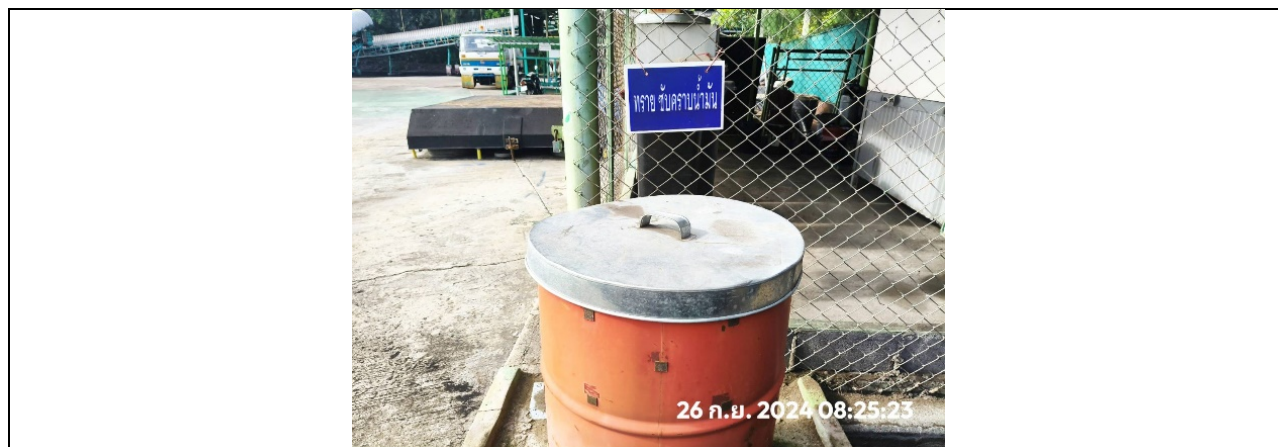
รูปที่ 2.2-33 ถังทราวดูดซับน้ำมัน
