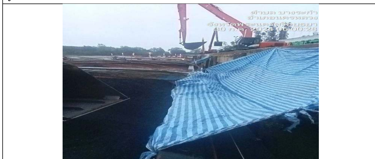
รูปที่ 2.2-11 การซิงผ้าพลาสติกกระหว่างท่ากับเรือตลอดแนวระวางสินค้าที่มีการขนถ่ายถ่านหิน
